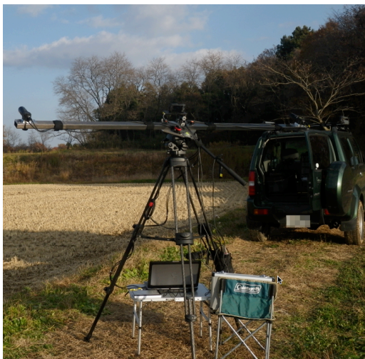
図1 開発したステレオ動画撮影装置
