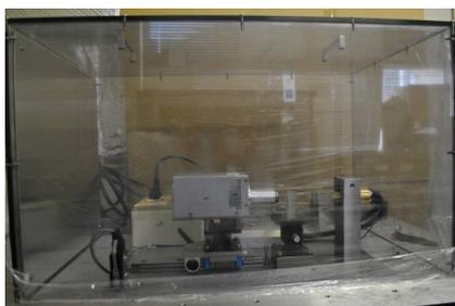
図2 in-situ X線吸収スペクトル測定装置の外観
