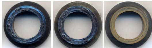
図4 700 °Cでの摩擦試験後のリング試験片の様子 (左: 無潤滑, 中: MoO<sub>3</sub> 潤滑, 右: C<sub>3</sub>Mo<sub>2</sub>O<sub>9</sub> 潤滑)
