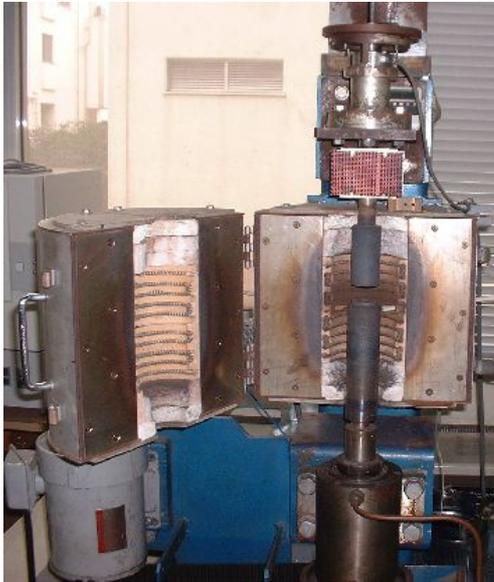
図1 摩擦試験装置
