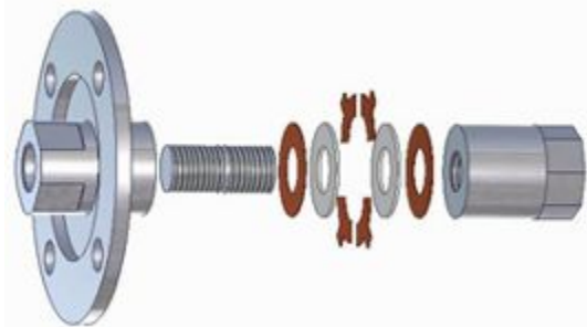
図 1 モータ駆動用ボルト締めランジュバン型振動子の概要
