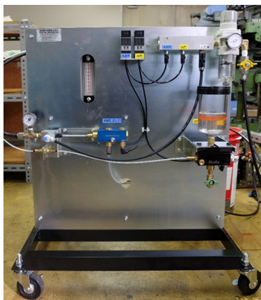
図3 改良した複合ミスト方式の加工液供給装置の外観
