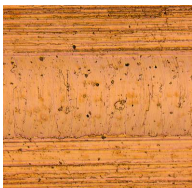
Fig. 8 Machined groove (1000mm/min)
