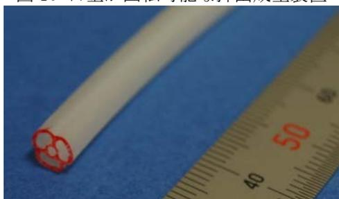
図 11 製造した螺旋捻転駆動装置
