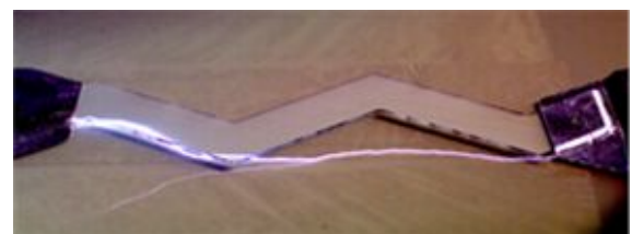
図11 複雑な形状のFRP板における沿面放電の例
