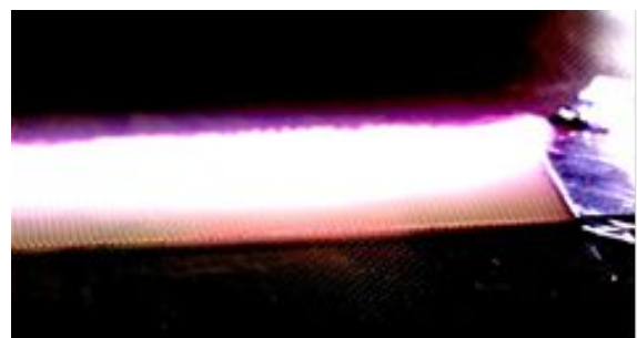
図10 電極に対し垂直なFRP板における沿面放電の例
