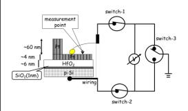
印加バイアス電圧に対する、Pt、Hf、O、Siのピーク位置の変化は、以前の測定結果と全く同じであり、特別な加工を施さなくても本プローブを用いて厚さ 4nm の Pt 膜上に電気コンタクトを得ることで、バイアス印加XPS 測定が可能であることを実証した。
