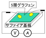
その結果、コンタクトプローブ間約 1mmにおいて抵抗値は約 3k となり、計算される電気抵抗率は  $8\times10^{-6}$  [ m]程度となった。この電気抵抗率は、無限層グラフェンであるグラファイトの電気抵抗率  $4.0\times10^{-7}$  [ m]酸化グラフェン還元を還元したグラフェン ( $2\sim10$  層)の電気抵抗率  $8.8\times10^{-5}$  [ m]と比較して、妥当な値と考えられ、本コンタクトプローブによる良好な電気接触が確認された。
