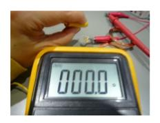
また、本コンタクトプローブを 2 個用いて、 サファイア基板に形成された5層グラフェン 膜の簡易的な電気抵抗測定を行った(下図参 照)
