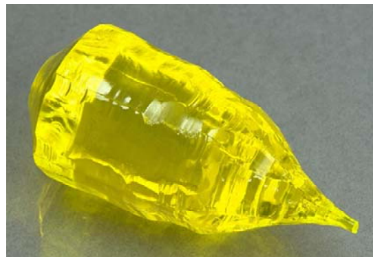
図 2 : 直径約 2 インチ Ce:YAG 単結晶蛍光体
