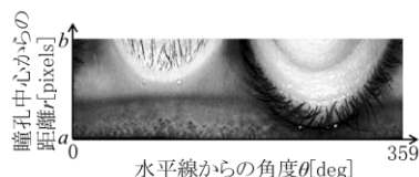
図2 極座標系に変換した虹彩画像
