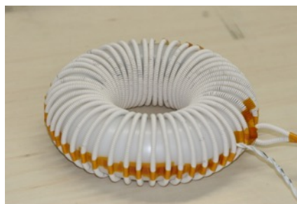
図 6 トロイダル型ベクトルポテンシャルコイル
