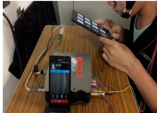
図7. SSVEPによる脳携帯システム
