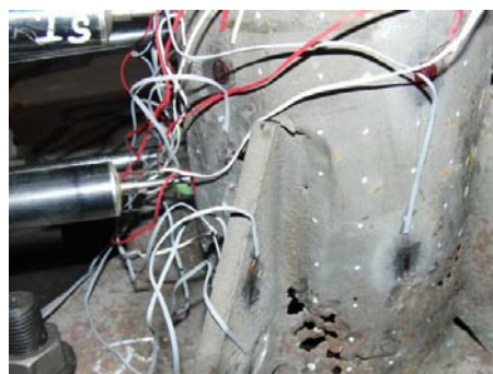
図 3 リブ付近の局部座屈（実験）
