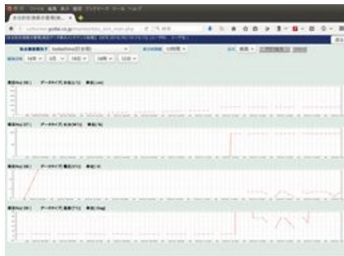
図7 静電容量型水位計による地下水位計測結果のWEBページによるリアルタイムのデータ公開(暫定)
