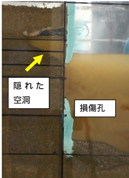
図3 空洞化再現実験による空洞化の観察
