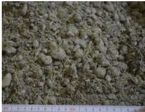
図-5 短繊維を混合した破碎コンクリート(再生路盤材)
