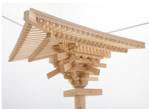
図5 屋根隅部 1/5 スケール実証模型
