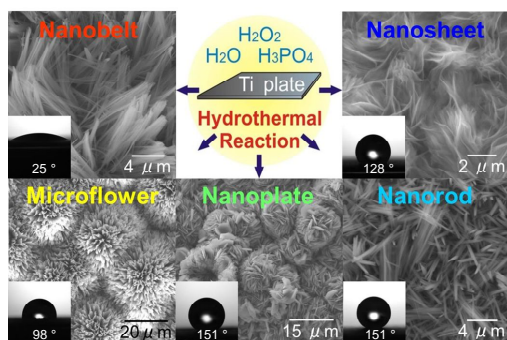
図 1 リン酸チタン薄膜の SEM 写真とドデシルアミンで表面修飾した後の水滴写真
