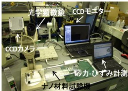
図3 ナノ材料試験システム
