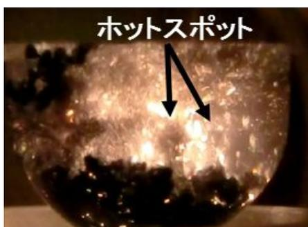
図1 Pd/AC 触媒表面でのハイスピードカメラによるホットスポットの写真
