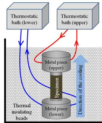
図1 一次元冷却システムの概略
