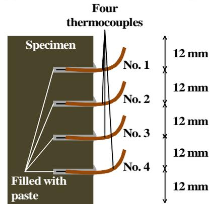
図2 供試体の内部温度の測定方法
