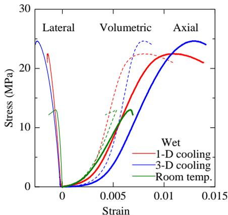
図5 応力-ひずみ線図の例(支笏溶結凝灰岩)
