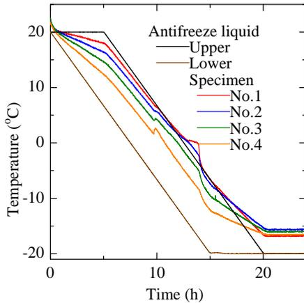
図4 一次元冷却時の供試体の内部温度の変化(支笏溶結凝灰岩)
