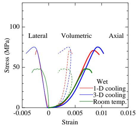
図6 応力-ひずみ線図の例(美唄砂岩)
