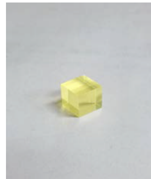
図2 GAGG結晶(1cm立方体)
