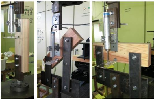
図5 加力方向を変えた釘接合部の1面せん断試験
