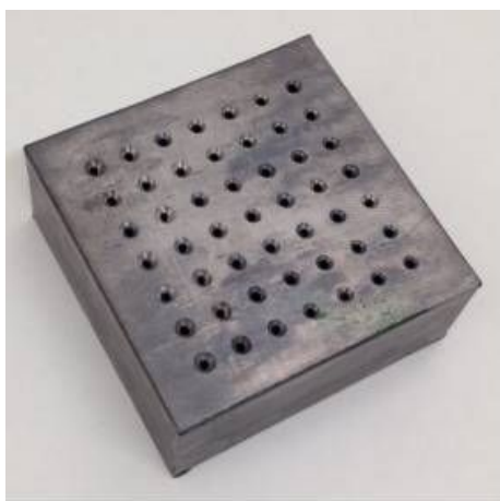
図9 鉛製線コリメータ(70 mm x 70 mm x 30 mm 厚)で整列させた30 mm厚の構造体である。
