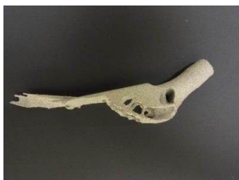
図7 試作したチタン合金製ステムの骨格
