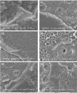
すべての歯質接着システムに関して、界面破壊が大半であった。2ステップシステム(MBとFA)では破断面に気泡は観察されなかった。1ステップシステムでは、HEMAを含む、含まないによらず多数の気泡が観察された。気泡の大きさに関しては、EBでは小さく、BFでは大きかった。気泡は、引張り応力を負荷してゆく過程で、破断の起点となる可能性があり、小さな応力で破壊が起こる原因の一つと考えられる。
