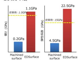
ナノインデンテーションの結果より、ワイヤ放電加工表面上(EDSurface)の骨組織は機械加工表面より骨組織として優れていることが分かった。
