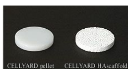
図1 緻密平板状 HAp 直径: 13mm 厚さ: 2mm
