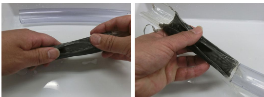
図 8 チューブ式電池セルの組立て
