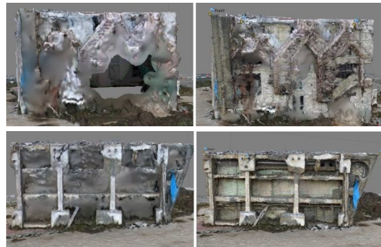
図5 空撮画像のみから構築した3Dモデルの詳細(左)と空撮画像と地上撮影画像を組合わせて構築した3Dモデルの詳細(右)
