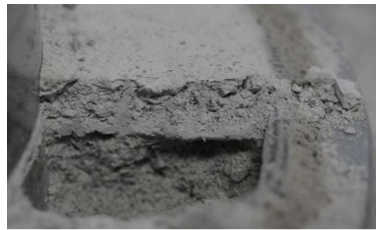
図 3 せん断により形成されたせん断ゾーン
