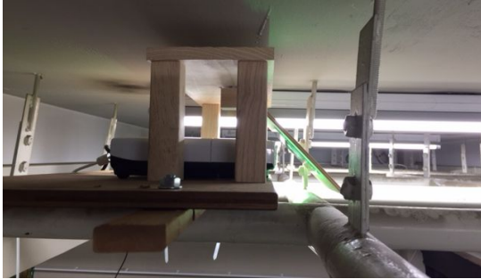
図 3 天井にプロジェクタを設置し、鏡を使って床に投影する（側面から）
