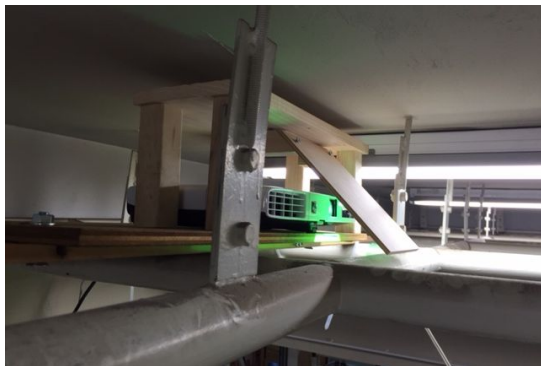
図 4 天井にプロジェクタを設置し、鏡を使って床に投影する（斜め前から）
