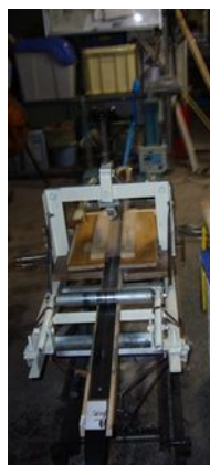
図3 スキー滑走面の鮫鱗皮グリップゾーンの擦動装置ゾーン(鉄枠下)面に角材を被せ加圧して擦動する。奥に駆動モータ。
