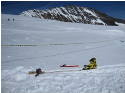
図5 鮫鱗皮シールにグライドワックスを施した滑走性能の試験風景
