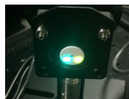
図7 プリズムにて分離された SHG 光 (左) と赤外光 (右)。なお、赤外線はターゲットに塗られた蛍光塗料により可視化した。
