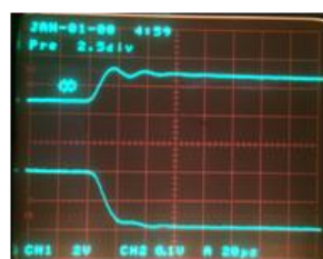
図 12 装置の応答速度の測定 上トレース：高圧電源の電位モニター、下トレース：光検出器から得られたシグナル。電位の変化にほぼ追従して光検出器から得られた信号の変化はほぼ電源電圧の変化に追従している。
