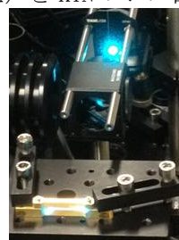
図5 扇型 pp 結晶 (手前) と発生した SHG 光 (奥) IR レーザーは波長 976nm、発生した SHG 光は 488nm。
