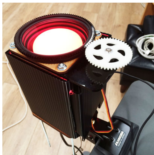
図9 Philips hue(フルカラーLED照明)にNDフィルター制御装置を取り付けた状態。
