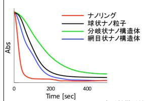
Pd の (111)面より(100)面の方が触媒活性が高い事実を考えると、この高活性はナノリングが(111)方向に成長し、リング表面の多くが (100)面であるためと思われる。さらに、最近格子欠陥である結晶粒界が高い触媒活性サイトとなることが報告されている。したがって、Pdナノリングに観測された多数の結晶粒界も高触媒活性の発現に寄与しているものと考えられる。
