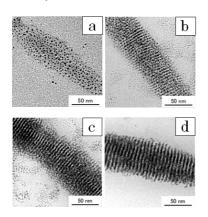
C18AA の分子集合体がナノリングのテンプレートとして機能しているのであれば、他の金属のナノリングも作製できると考えられる。そこで、Pt および Pd-Ni 合金ナノリングの作製に挑戦したところ、それらのナノリ
