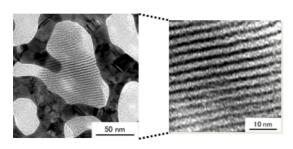
さらに、ナノリングの生成機構を検討するために、生成途中の TEM 観察を行ったところ、下図のように塩化パラジウム酸カリウムを添加した後に還元剤を加えると、C18AA の鋳型上にまずパラジウムナノ粒子が生成し、それが成長・融合してナノリングが生成することが判明した。10 分後(c)にはテンプレートに沿って一次元配列し、30 分後(d)にはナノリングが生成するといった過程が観察された。以上のことから、ナノリングの生成機構が明らかとなった。
