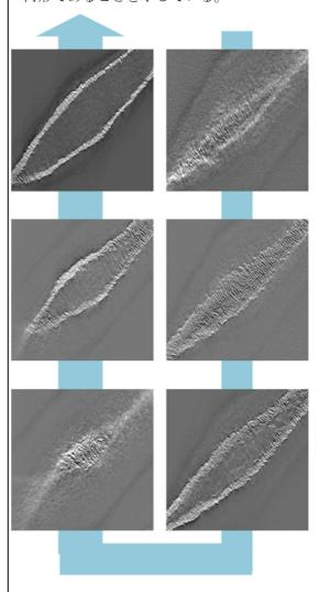
さらに、試料を高角度( $-56\sim62^{\circ}$ C)に傾斜させながら、連続的に TEM 像を撮影し、一連の連続傾斜像からその切片の三次元情報を再構築したもの(TEM3D トモグラフ)を上図に示す。図から明らかなように、ナノリン
