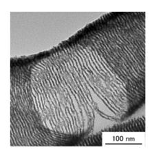
Pd ナノリングを 5 サンプル作製し、それぞれの試料の 20 個(計 100 個)のサイズを測定した結果、リング間距離は  $4.06\pm0.31$  nm、リング径は  $145\pm53$  nm および長さは  $1030\pm318$  nm であった。ひとつひとつのリングの幅が数 nm のナノリングが連なっている構造体を、1 ステップで作製できる報告例はこれまでになく、簡便な作製方法でナノリング構造体を作製することができた。また ICP 発光分光分析によりナノリングの収率を算出したところ、約 56.5%であることがわかった。
