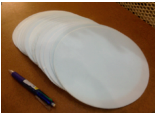
図2 発泡ポリスチレン性 RT-MLI の一例
