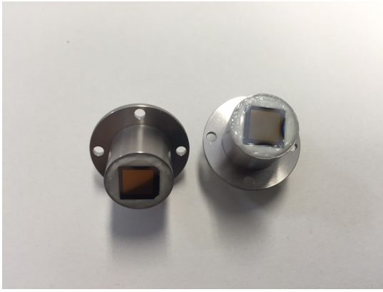
図6 メタマテリアル超音波振動子の外観。シリコン基板の表面には図3に示した様なスプリットリングとバーを組合せた構造が金蒸着されている。裏面には圧電体 ZnO トランスジューサーが塗布されている。
