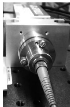
図7. 励起光源とファイバークップリング機構
