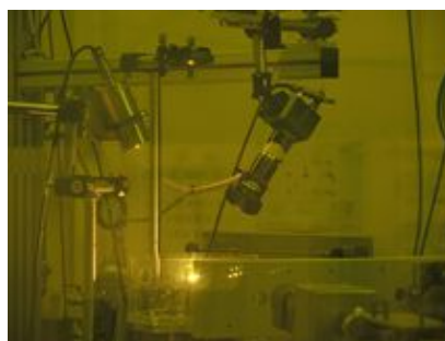
図 3. 超高温下での回折実験。二次元検出器により粒成長の影響を削減した。
