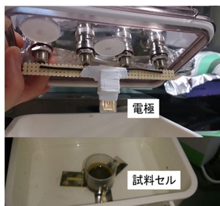
Figure 2. 4 端子測定電極の例 実際には、電極接続部は、ポリスチレンなどで防水加工を施し、嫌気性容器内に置いた試料溶液と電極面だけで接触する構造とした。また端子は気密端子を用い、嫌気雰囲気を保つ構造である。試料操作は、アク
