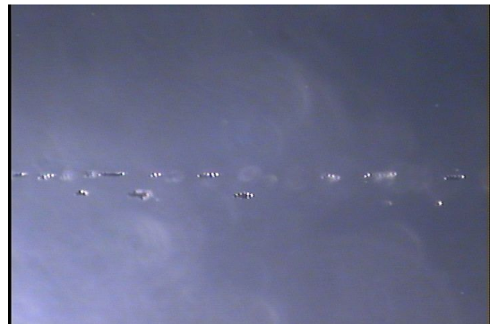
図5 30 nm (上側)と 90 nm(下側)金薄膜層粒子の分離。超音波トランスデューサーへの印加電圧、10.4 V。
