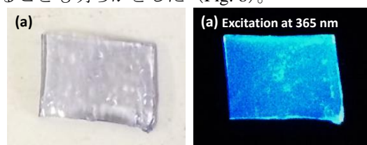
Fig. 8 カーボン系発光材料を用いたコンポジットフィルム (a)励起光照射前(b)励起光照射後(励起波長は 350 nm).
