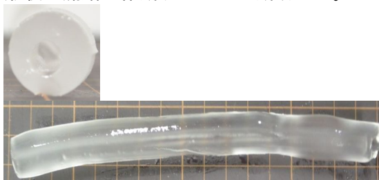
図 3D プリンターで作製した型を用いて作成されたチューブ状のソフト&ウェット流路
