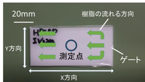
図 1 成形した PP 試料の写真(厚さ 2.5mm)
