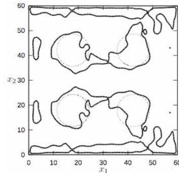
図5 トポロジー最適化によって得られた散乱体の最適分布
