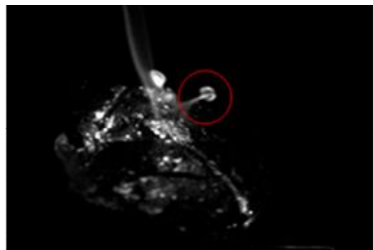
図 4 石炭粒子表面からのガスの噴出し(赤丸で示した部分)
