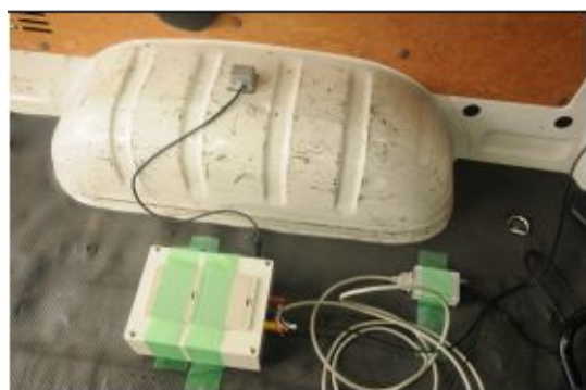
図 12 センサの車内設置状況
