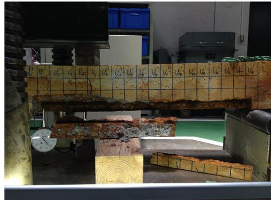
図13 RC 曲げ載荷実験時の様子
