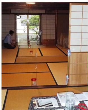
写真3 ミセノマから縁側への通風の測定
